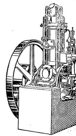
Motor para aceites pesados sin válvulas sin magneto, adecuados para trilladoras
