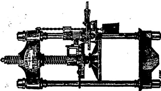
Este nuevo sistema de prensas está llamado á hacer verdadera revolución entre los cosecheros de estos caldos, porque su diferente velocidad y su mecanismo de palanca múltiple sobre la columna de la prensa movida por una sola manga de palanca de doble efecto, alcanza mucha más fuerza y adelanta muchísimo en el trabajo.
