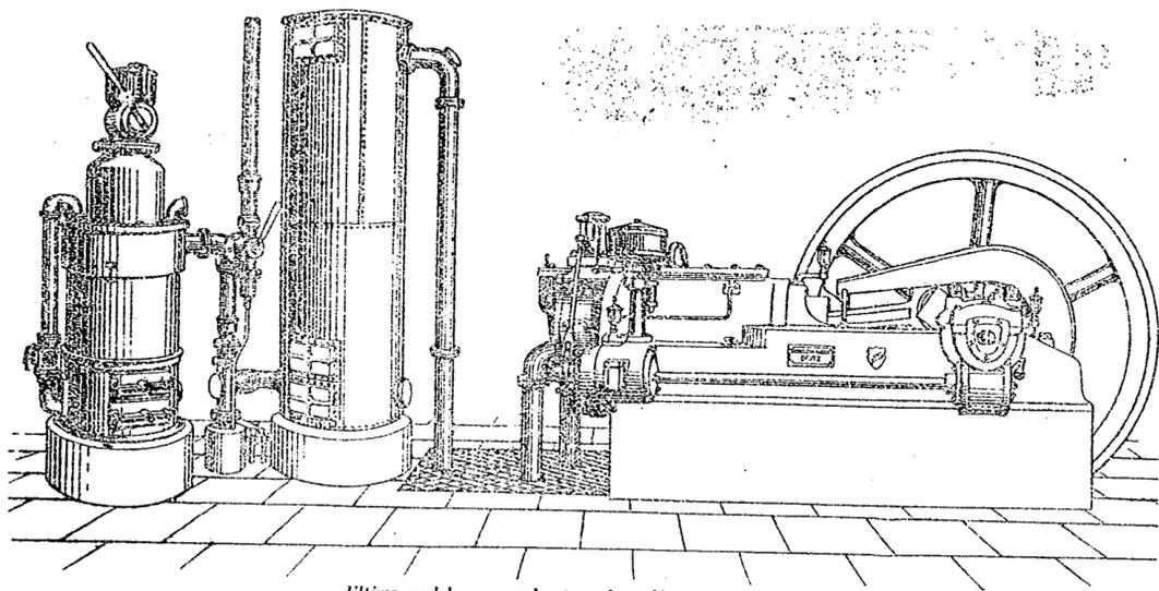
Ultimo modelo a gas pobre transformable en motor Diesel para creosotas.
